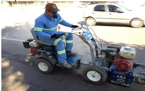
Figura 1 - Remoção de Sinalização Horizontal.
